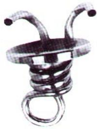
CONDENSADOR PARA FRASCO EXTRATOR DE GORDURAS
