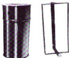
CILINDRO PARA ESTERILIZAR PLACAS DE PETRI
