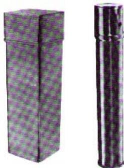
CAIXA E CILINDRO PARA ESTERILIZAR PIPETAS
